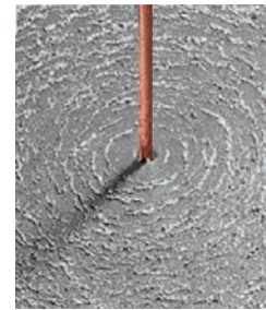
चित्र 13.6 (a) किसी विद्युत धारावाही सीधे चालक तार के चारों ओर के चुंबकीय क्षेत्र की क्षेत्र रेखाओं को निरूपित करता संकेंद्री वृत्तों का पैटर्न। वृत्तों पर अंकित तीर क्षेत्र रेखाओं की दिशाओं को दर्शाते हैं (b) प्राप्त पैटर्न का समीप दृश्य
