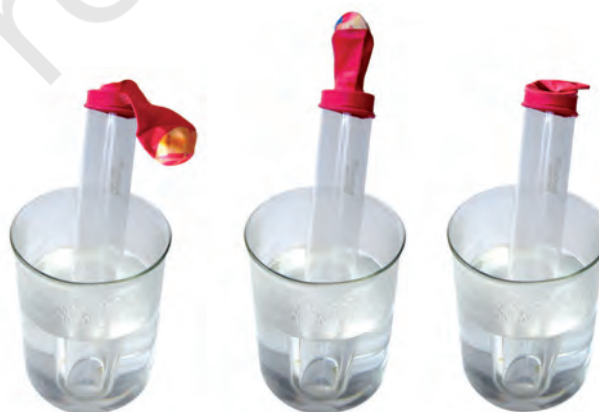
क्वथन नली के मुख पर बँधा गुब्बारा गर्म जल में डूबी हुई क्वथन नली बर्फ के ठंडे जल में डूबी हुई क्वथन नली
