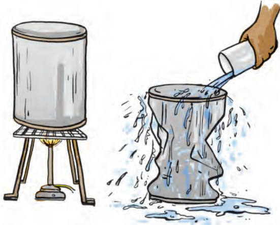
चित्र 8.2 गर्म जल से भरा डिब्बा जिसे ठंडा किया जा रहा है
